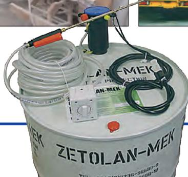
LEYCO MV 7 "airless" Feinsprühgerät mit Zeituhr
